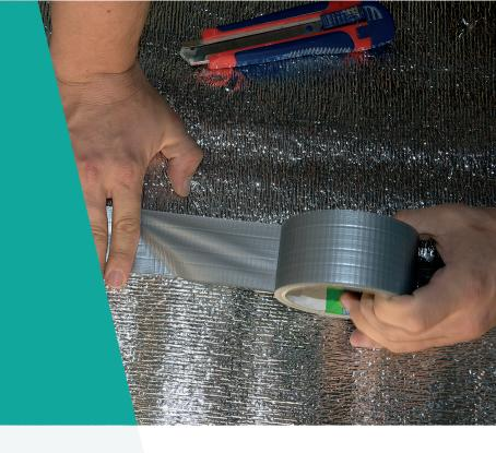
В процессе производства **армированной клейкой ленты VINTANET**, тонкую газовую ткань, называемую «сеткой», ламинируют на подложку из полиэтилена низкой плотности (LDPE). Цвет полиэтилена обеспечивается различными пигментами. Серебряный цвет ленты получается от смешения порошкообразного алюминия с LDPE. Армированные ленты VINTANET прочные на растяжение, но при этом рвутся руками. Надежно клеятся к разным поверхностям и устойчивы к механическим воздействиям.
