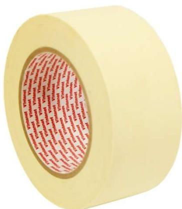
**Основа:** крепированная бумага**Адгезив:** клей на основе натурального каучука**Толщина общая, мкм:** 160**Адгезия к стали, Н/25 мм:** 5**Предел прочности, Н/25 мм:** 65**Рабочий диапазон температур:** +5°C ... +120°C**Температура нанесения:** +10°C ... +40°C**Срок годности, мес.:** 12**Применяется:**
